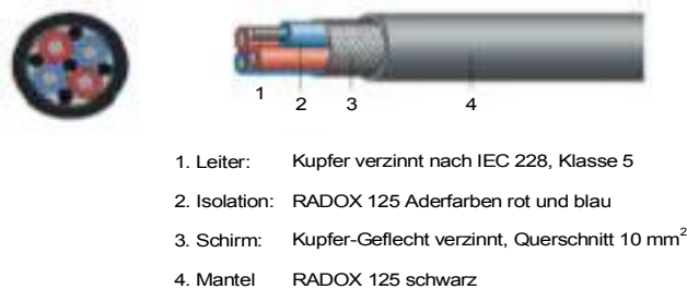
Bild 13: Aufbau des RADOX 125 Kabels.
